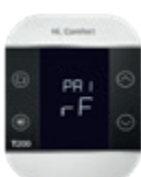
Na wyświetlaczu T200 pojawi się komunikat o parowaniu.
