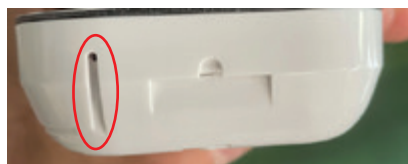
Na programatorze T200 wcisnąć jednorazowo przycisk w obudowie – cienikiem narzędziem (brak w zestawie).
