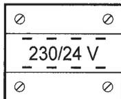
Der überlastsichere HERZ-Sicherheitstransformator (230 V/24 V) ist für den Anschluß der HERZ-Raumthermostate und HERZ-Thermomotoren vorgesehen und für den Betrieb von max. 8 HERZ-Thermomotoren geeignet.
